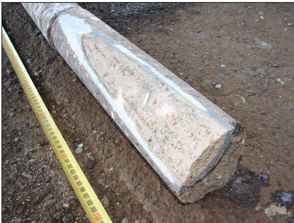
Foto 3: 2. nástupiště, základ sloupu 11, jádrový vývrt 2; azbestocementová roura vyplněná cementovou maltou
