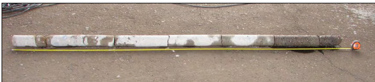
Foto 15: 3. nástupiště, základ sloupu 4 (Zpráva 1600 J 195 [11], Příloha 3, foto 61); vizuálně se beton základu jeví jako beton lepší kvality oproti betonu základů sloupů 13 a 2 na 3. nást. diagnostikovaných v tomto doplňkovém STP
