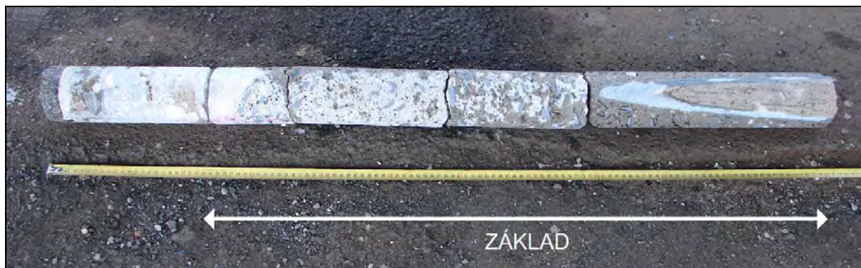
Foto 2: 2. nástupiště, základ sloupu 11; jádrový vývrt po odběru
