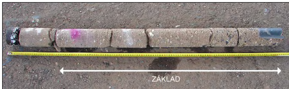
Foto 8: 3. nástupiště, základ sloupu 2; jádrový vývrt po odběru
