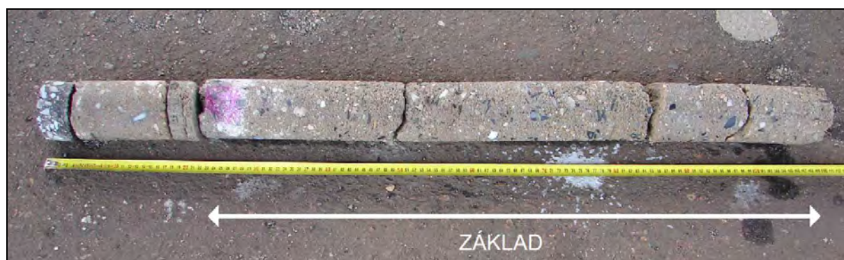
Foto 7: 3. nástupiště, základ sloupu 13; jádrový vývrt po odběru
